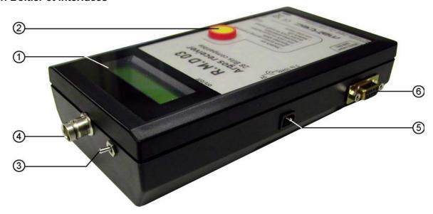
Le récepteur, le processeur et la pile sont protégés par un boîtier plastique portatif de dimensions 195 x 100 x 44 mm. Le panneau supérieur comprend un écran LCD 2 x 16 caractères (1) et un bouton poussoir de démarrage (2). Ce bouton poussoir est également utilisé pour accéder à d'autres fonctions.
