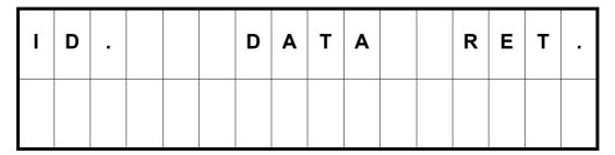
L'accès au mode à sélectionner se fait par les fonctions SHIFT puis SELECTION. Le mode RET. permet de retourner au menu précédent.
