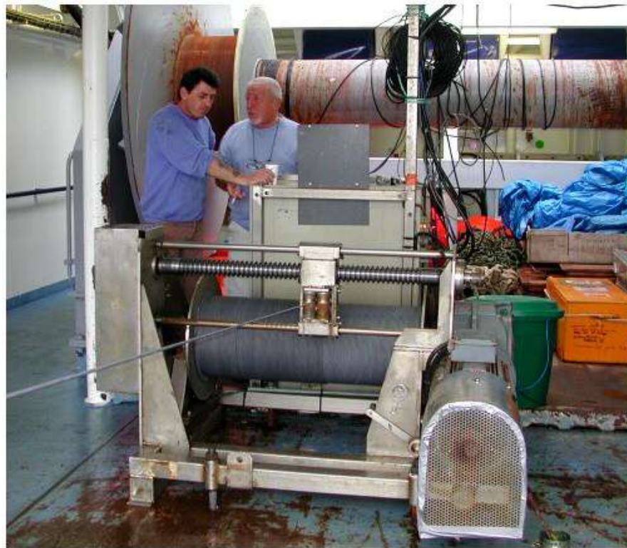
Le treuil Towyo est équipé d'un câble électroporteur de diamètre 6 mm. Longueur 2500 m (poids : 500 kg)
