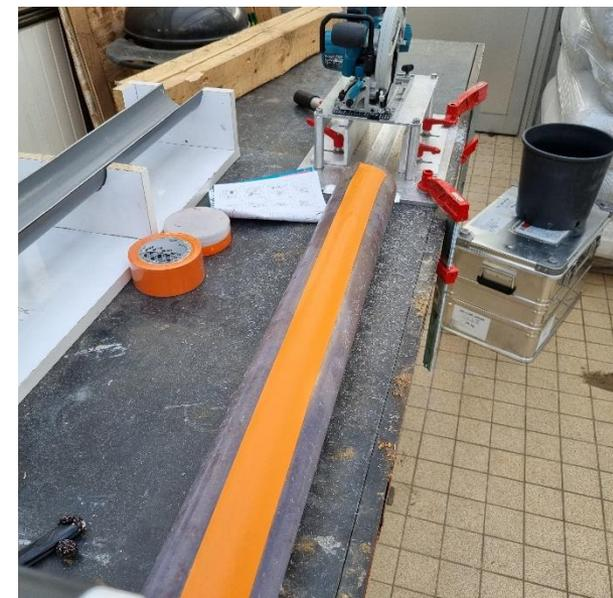
**CAPACITÉ: Liners de  $\varnothing 65\text{mm}$  à  $\varnothing 108\text{mm}$ . Pour ICOS Barbeau ouverture de 100 carottes de 1m.**
