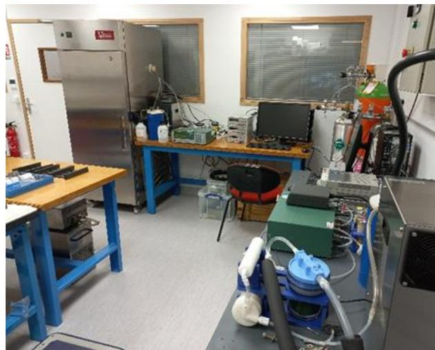
Figure 186 : Les 2 bancs d'étalonnage à Gif-sur-Yvette, avec l'armoire thermostatée et les bouteilles de CO<sub>2</sub> étalons
