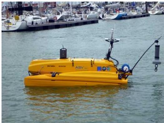
Figure 135 : Test du treuil avec une charge fictive
