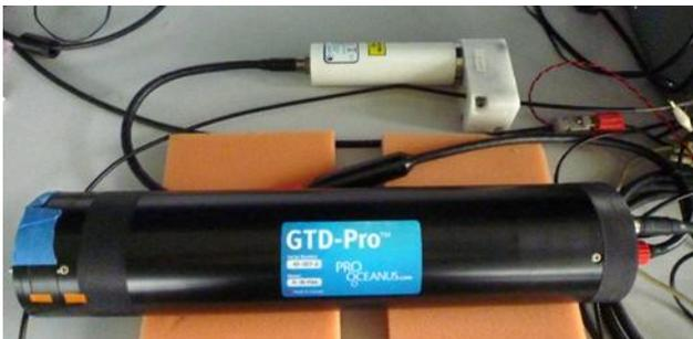
Figure 149 : Capteur GTD avec le modem inductif UIMM de communication sur la ligne
