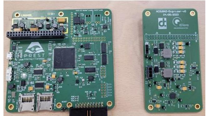
Figure 5 : Cartes électronique  $\mu$ C et ADC du système, à plat avant assemblage
