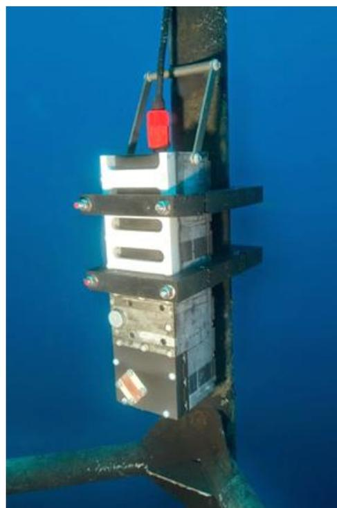
Figure 28 : Capteur pCO<sub>2</sub> déployé sur la bouée Boussole
