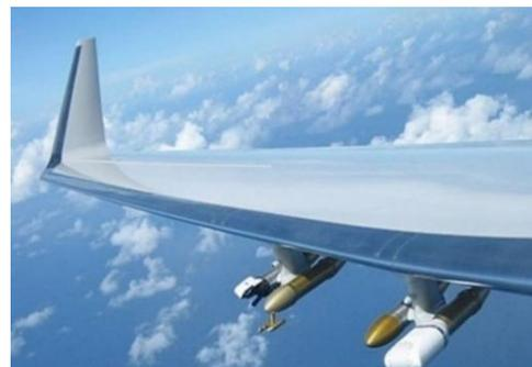
Figure 48 : Localisation de l'extinctionmètre sur un aéronef
