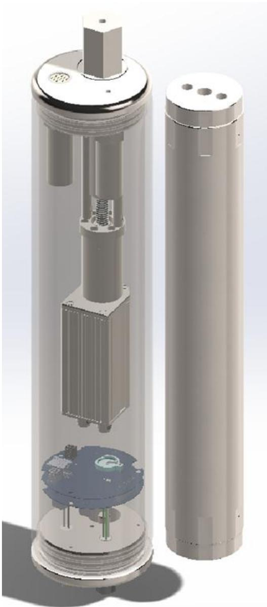
Figure 96 : Etude mécanique de HPSU, vue d'ensemble du régulateur et d'une bouteille d'échantillonnage
