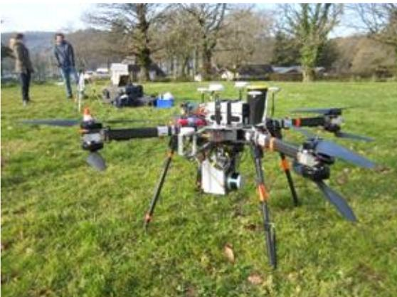
Figure 91 : Drone aérien gros porteur HyperDrelia avec une charge utile max de 7 kg
