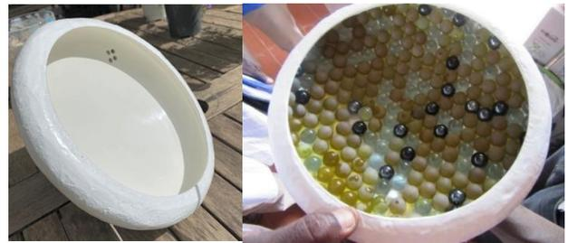
Figure 50 : Vue du frisbee inversé « new » de 250 mm de diamètre, à droite rempli d'une couche de billes
