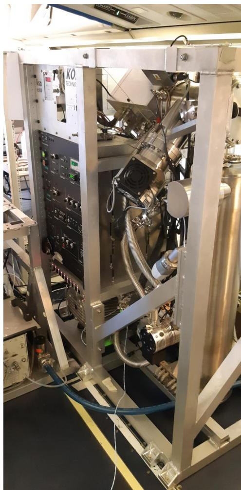
Figure 159 : PTR-ToF-MS dans la cabine de l'avion en mai 2022, où il doit composer avec de nombreux autres châssis et baies
