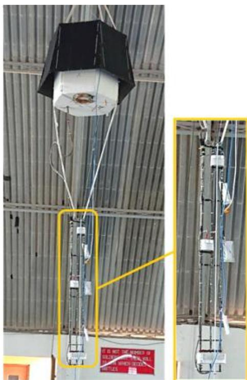
Figure 140 : Cellule optique de Pico-SDLA attachée sous la nacelle Zéphyr
