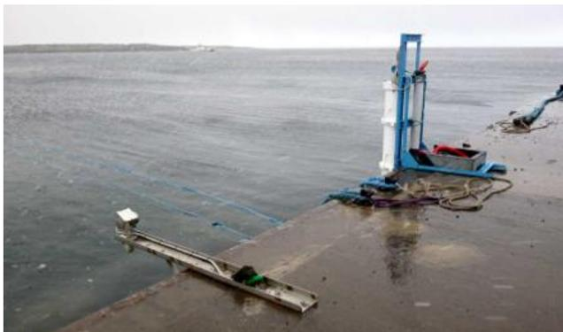
Figure 129 : Radar et tube marégraphique à Kerguelen
