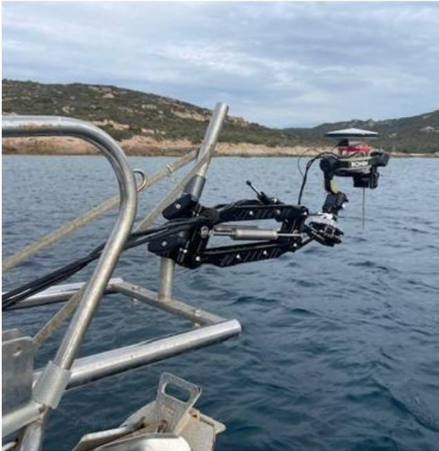
Figure 60 : Système Cyclopée monté à l'avant du navire : altimètre acoustique, antenne GPS, inclinomètre montés sur bras stabilisateur
