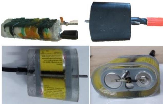
Figure 43 : Différents prototypes réalisés et qualifiés pour 1000 m. Celui du bas a été retenu pour le projet et est reproduit pour les premiers déploiements en 2025.
