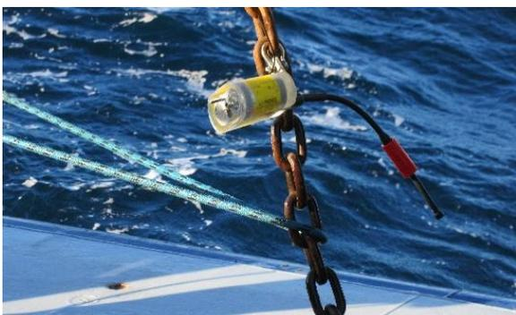
Figure 44 : Prototype prêt à être déployé à 1000 m de profondeur
