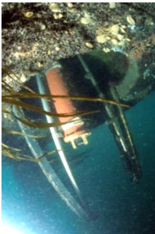
Figure 111 : Capteur pCO<sub>2</sub> sous la bouée Marel Iroise
