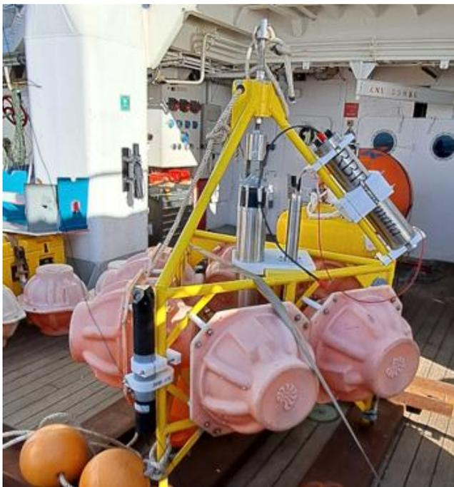
Figure 112 : Déploiement des capteurs de pression lors de la mission SWOT-NC
