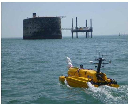
Figure 137 : Mini-Cyclopée en mesure sur des traces satellites altimétriques devant Fort Boyard
