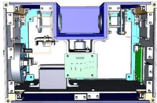
Figure 77 : CAO de l'intérieur du nouveau dispositif End Point pour les mesures de titration par colorimétrie
