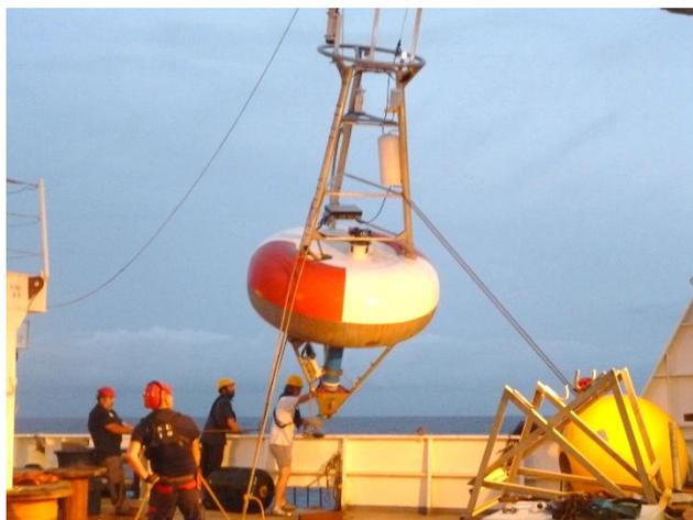
Figure 148 : Mise à l'eau d'une bouée Pirata équipée d'un capteur pCO<sub>2</sub>
