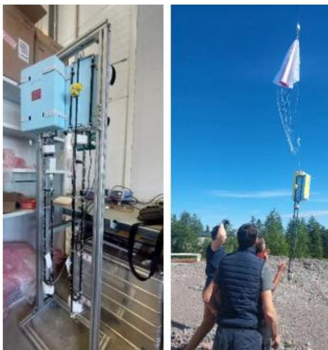
Figure 145 : A gauche, assemblage intégrations et tests des 2 instruments Pico-Light H2O-BLD. A droite, lâcher durant la seconde session.
