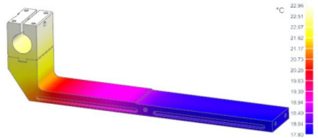
Figure 168 : Températures calculées pour 10 W dissipée avec un refroidisseur déporté en cuivre
