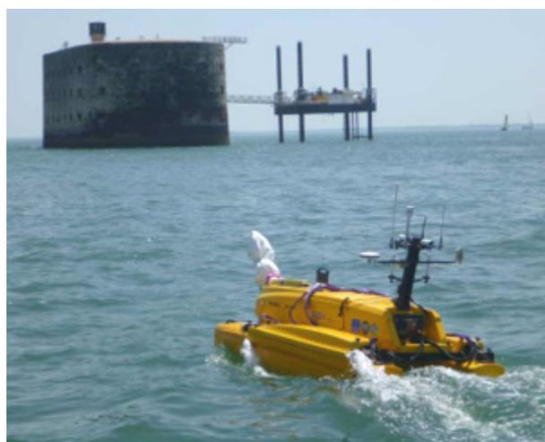
Figure 156 : Mini-Cyclopee en mesure sur des traces satellites altimétriques devant Fort Boyard
