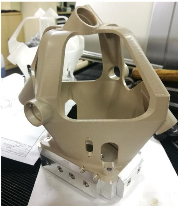
Figure 88 : Prototype de structure usinée
