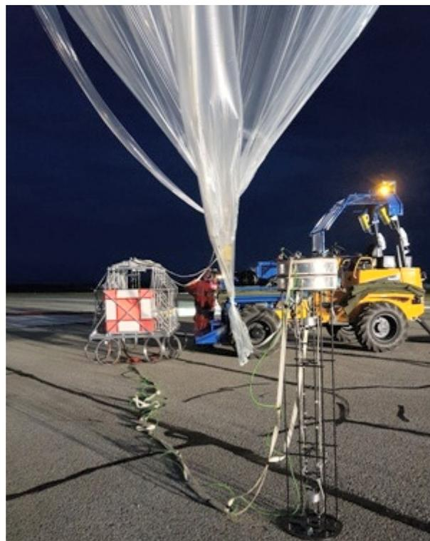
Figure 179 : Photographie de la nacelle CLIMAT juste avant le lancement (11/08/2018, 00:30 UTC). On peut voir l'hygromètre Pico-SDLA H<sub>2</sub>O à l'avant plan et la nacelle contenant tous les autres instruments à l'arrière
