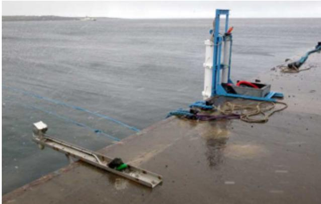
Figure 147 : Radar et tube marégraphique à Kerguelen
