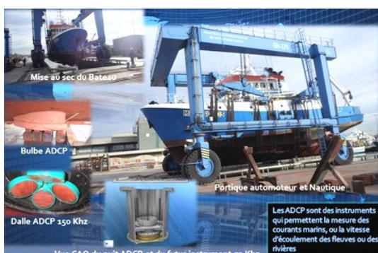
Figure 241 : Travaux de remplacement de l'ADCP du *Téthys II*
