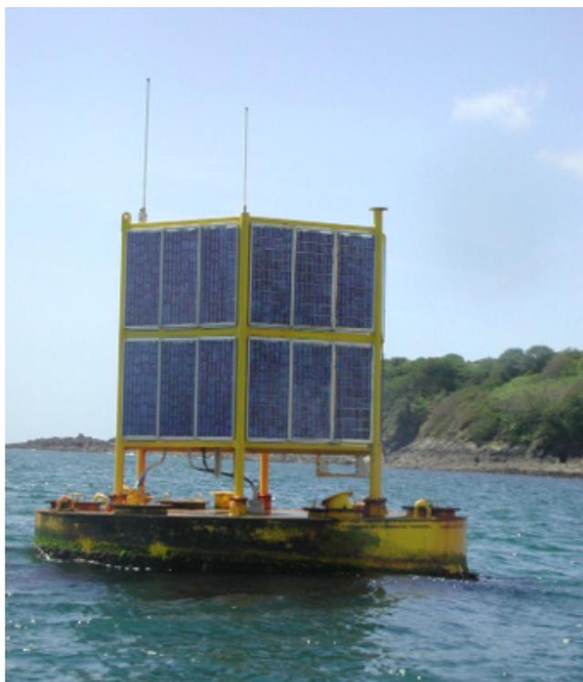
Figure 118 : Bouée Marel Iroise équipée d'un capteur pCO<sub>2</sub>
