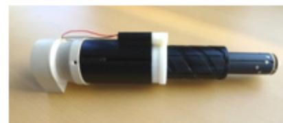
Figure 68 : De haut en bas, guide d'ions déployé, guide d'ions rentré, guide d'ions motorisé
