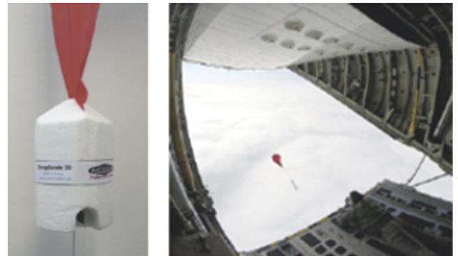
Figure 39 : Drop-sondage par avion (sonde MODEM)
