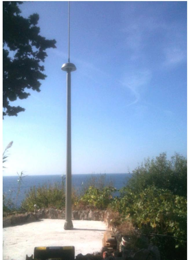
Figure 200 : Radar courantométrique au phare de Saint-Jean-Cap-Ferrat
