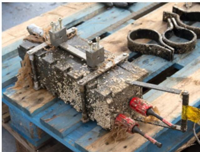
Figure 210 : Capteur pCO<sub>2</sub> lors de sa récupération après 14 mois dans l'eau
