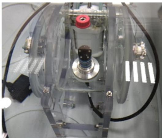
Figure 84 : Tests d'étanchéité à l'oxygène dissous en laboratoire (MIO)
