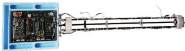
Figure 172 : L'hygromètre Pico-Light H2O
