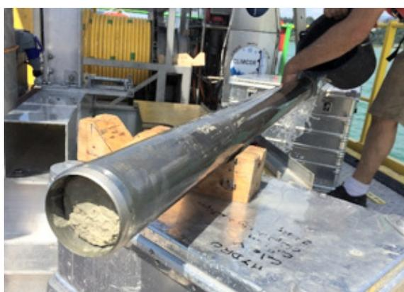
Figure 291 : Carotte encore en place dans le carottier HYDRO
