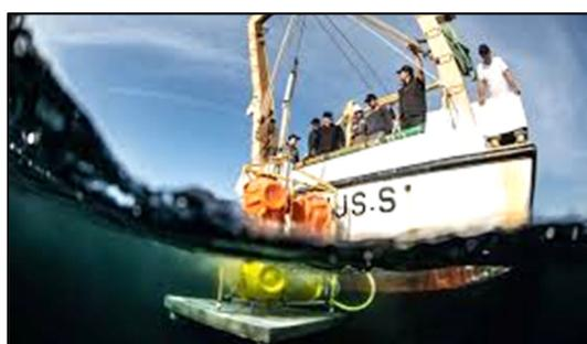
Figure 254 : Mise à l'eau de la cage de fond instrumentée au large d'Istanbul dans le cadre du projet EMSO-MARMARA
