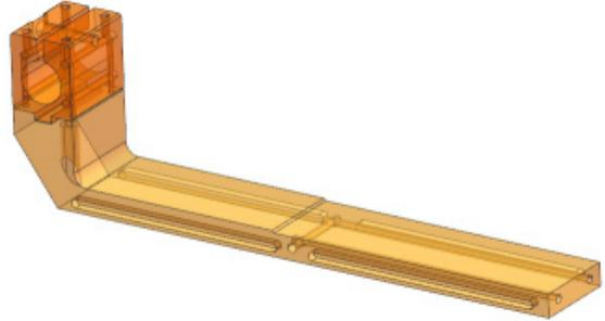
Figure 167 : Proposition de montage déporté avec circulation d'eau seulement dans la partie droite
