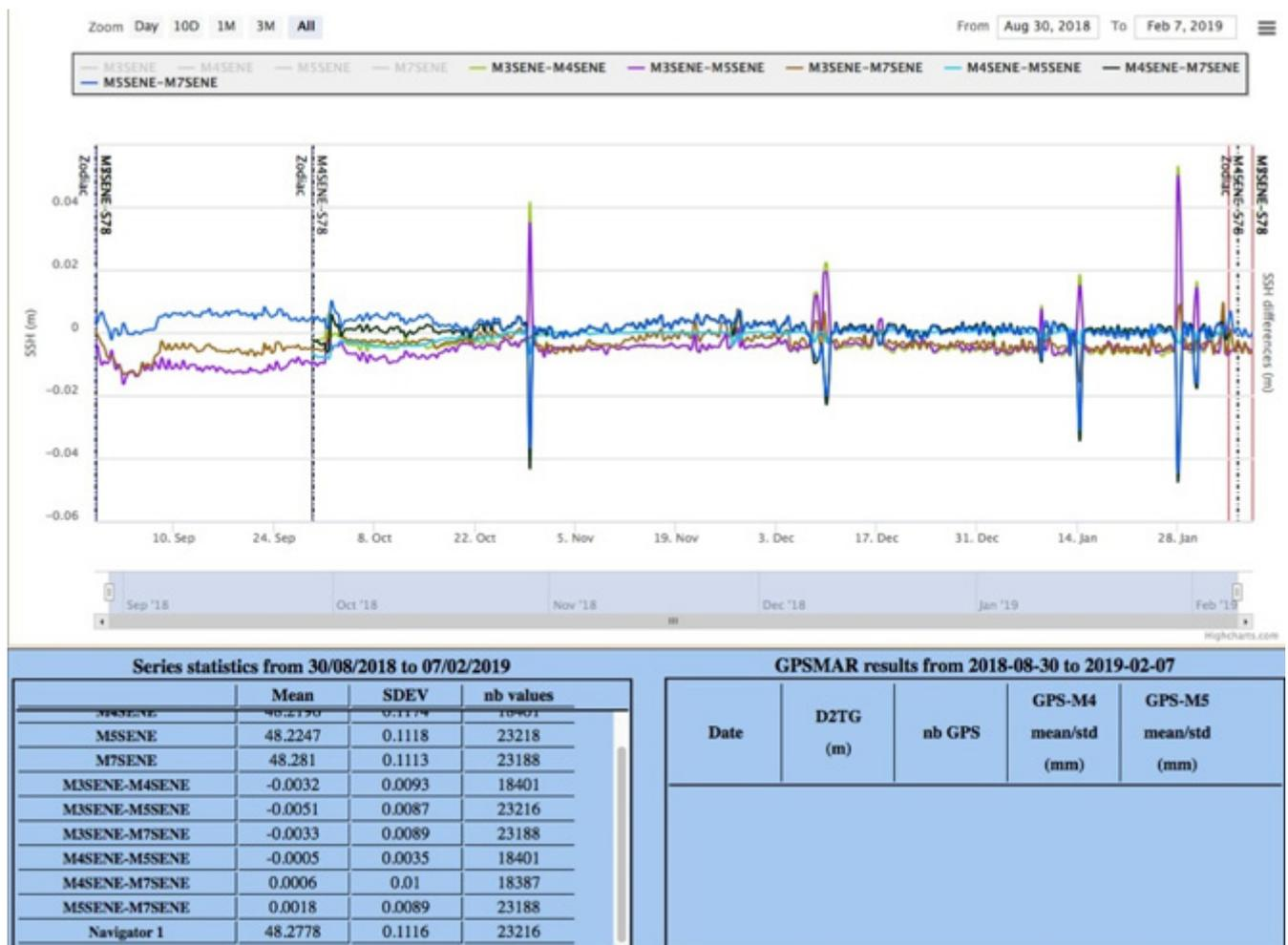
Figure 117 : Comparaison entre les 4 marégraphes de Corse M3, M4, M5 et M7. Les différences de niveaux observées (sur la moyenne Mean et la déviation SDEV) sont meilleures que le centimètre.
