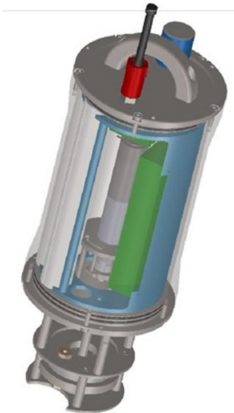
Figure 46 : Dessin de l'échantillonneur haute résolution
