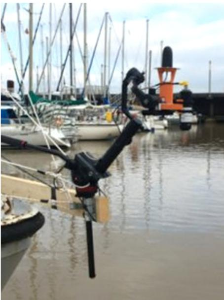
Figure 31 : Système Cyclopée monté à l'avant du navire : altimètre acoustique, antenne GPS et inclinomètre montés sur bras stabilisateur
