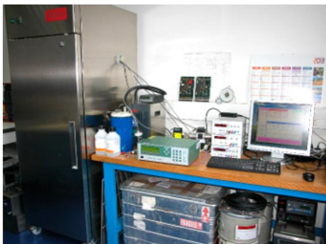
Figure 279 : Un des 2 bancs d'étalonnage, avec son armoire thermostatée
