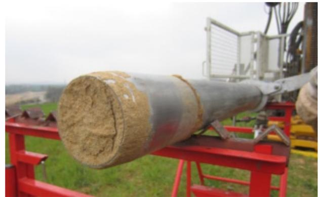
Figure 301 : Trousse coupante et carotte de loess
