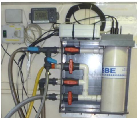
Figure 237 : Thermosalinographe Seabird SBE21
