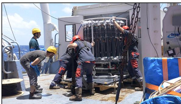
Figure 255 : CTD/rosette Trace Metal Clean lors de son transfert à l'intérieur du conteneur chimie propre
