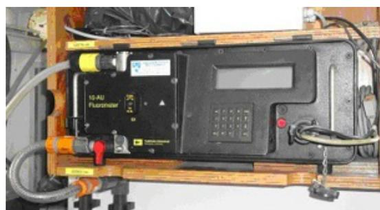
Figure 238 : Fluorimètre Turner Designs 10-AU-500
