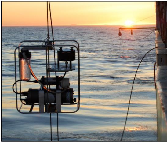
Figure 135 : Pompe in-situ déployée lors de GEOVIDE
