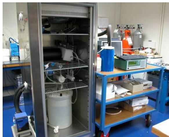
Figure 145 : Banc d'étalonnage avec son armoire thermostatée et les bouteilles de CO 2 étalon
