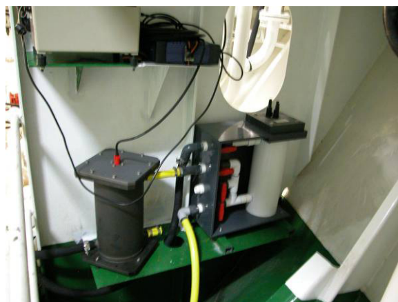
Figure 7 : Capteur pCO 2 Carioca (à gauche) installé en série avec un TSG (à droite) sur le MN Colibri
