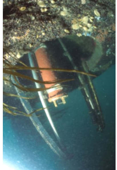
Figure 10 : Capteur pCO2 sous la bouée Marel
