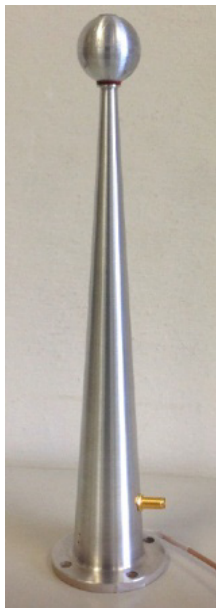
Figure 78 : Electrode physique de Micro-ARES
