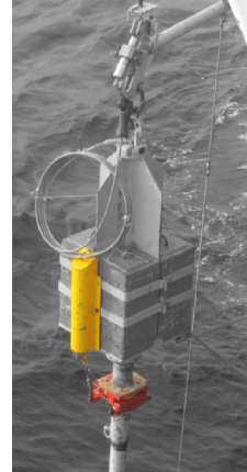
Figure 156 : Mâchoire de largage sur Calypso II
