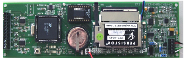
Figure 161 : Carte datalogger pour marégraphe
