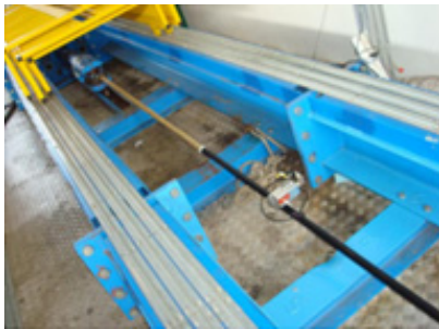
Figure 157 : Tests de câbles textiles sur banc de traction
