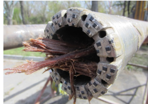
Figure 150 : Tête du tube de forage
