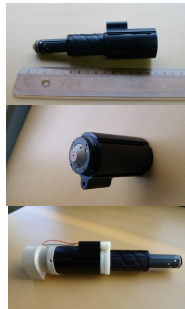
Figure 61, de haut en bas : Guide déployé ; Guide d'ion rentré ; Guide d'ion motorisé
