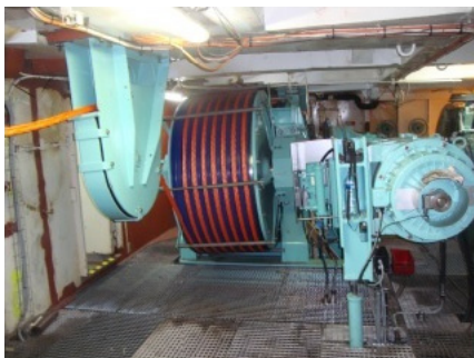
Figure 22 : Treuil 45 t installé à bord du Marion Dufresne II
