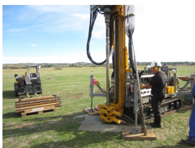
Figure 23 : Sondeuse 250-90 pour les activités terrestres
