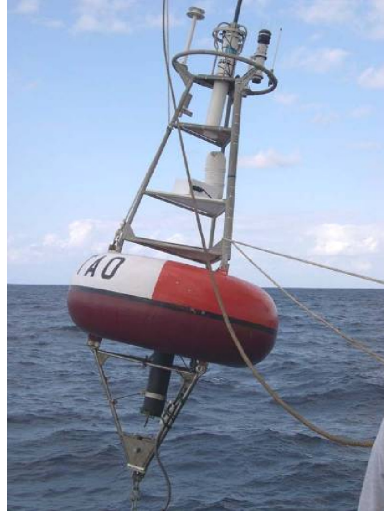
Figure 9 : Mise à l'eau d'une bouée Pirata
