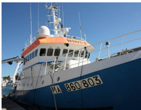
Figure 100 : Le Téthys II avec son antenne VSAT
