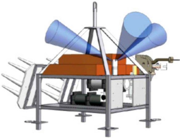
Figure 71 : Vue 3D du Module Interface Instrumenté version 1 déployé pour ESONET
