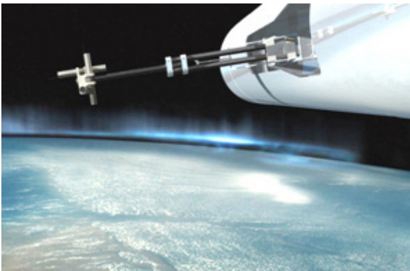
Figure 166 : Vue du magnétomètre ICI installé au bout du bras sur la fusée sonde
