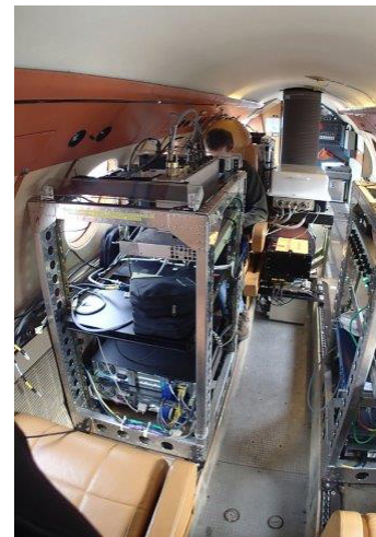
Figure 65 : HRS : Interféromètre Mach-Zehnder (optique et électronique de détection)
