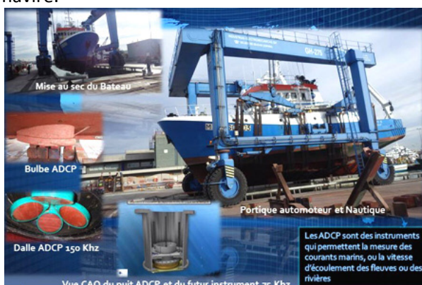
Figure 129 : Travaux de remplacement de l'ADCP du Téthys II
