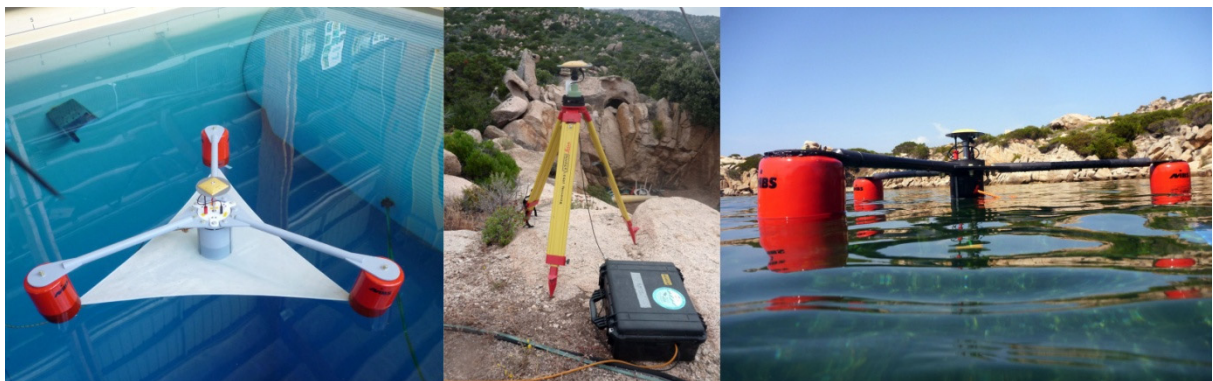
Figure 112 : Bouée GPS au bassin d'essai, station GPS de base à terre, bouée GPS sous la trace du satellite Jason2 sur le site de mesures de Senetosa.
