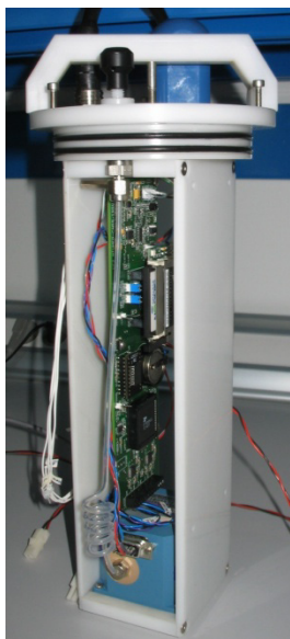
Figure 108 : Marégraphe DT. Capteur de pression Paroscientific. Stabilité thermique: +/-0.05 mbar/°C. Hystérésis +/- 0.18 mbar
