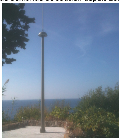
Figure 97 : Radar courantométrique type CODAR Seasonde du phare de St Jean Cap Ferrat.
