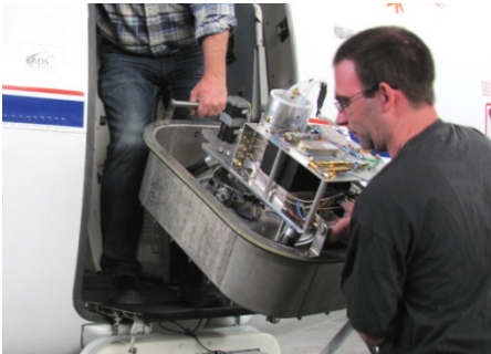
Figure 62 : Intégration de KuROS V1 dans l'ATR 42
