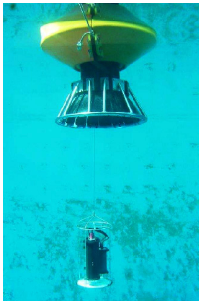
Essai de la bouée PL en bassin
