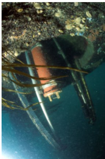
CAPTEUR PCO2 SOUS LA BOUEE MAREL
