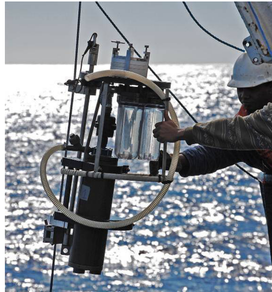
Déploiement de pompe in-situ
