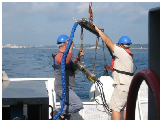
Mise à l'eau du canon à air mini GI
