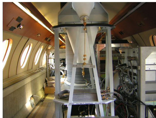
Intérieur du Falcon 20 (vue vers l'arrière) avec, au premier plan, le châssis du radar RASTA
