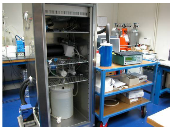
Banc d'étalonnage avec son armoire thermostatée et les bouteilles de CO 2 étalon (dans le fond)
