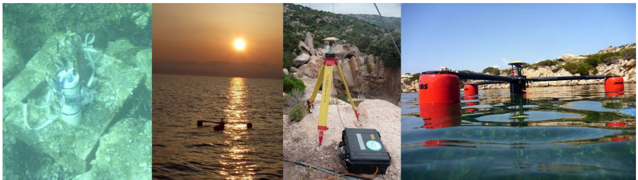
Intercomparaison : marégraphes DT-INSU/Anderaa WLR7 à 5 m de fond, bouée GPS sous la trace du satellite Jason2, site de mesures de Senetosa : station GPS sur terre, bouée GPS en surface.
