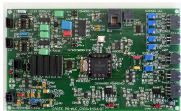
A gauche : Cellule de mélange. A droite : Carte électronique
