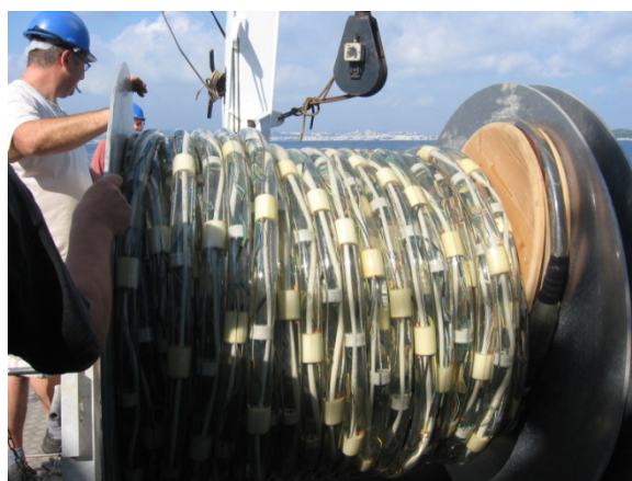
Mise à l'eau de la flûte sismique
