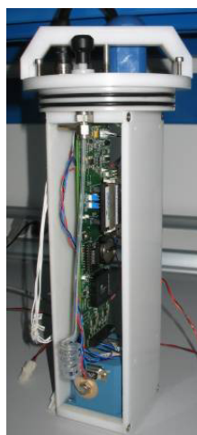
Marégraphe DT-INSU : capteur de pression Paroscientific, stabilité thermique \pm 0,05 mbar/°C, hystérésis \pm 0,18 mbar, offset \approx 0 mbar.
