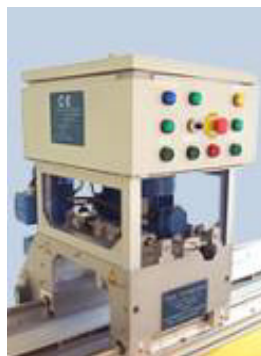
Banc de découpe de carottes sédimentaires
