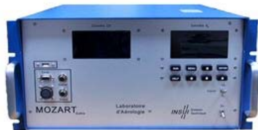
Exemplaire du Service des Avions Français Instrumentés pour la Recherche en Environnement (dimensions 19" 5U, masse 29 kg)
