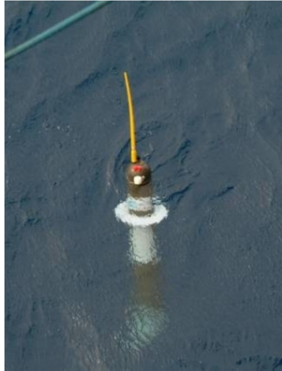
Mise à l'eau d'un flotteur Provor
