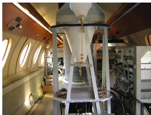
Intérieur du Falcon 20 (vue vers l'arrière) avec, au premier plan, le châssis du radar RASTA
