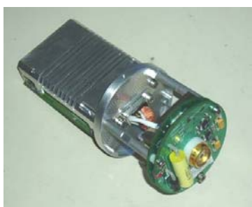
Photodiode à avalanche et convertisseur analogique digital de la voie IR du lidar LNG
