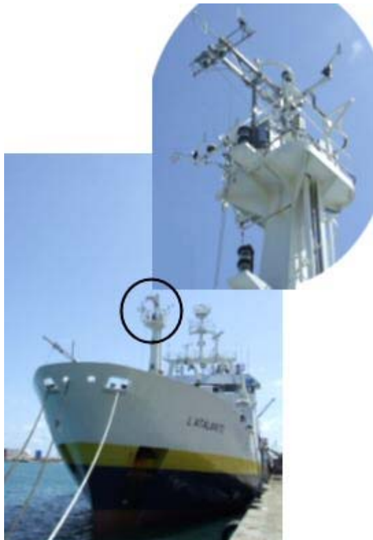
Implantation de l'instrumentation de mesure de flux sur le mât de l'Atalante (2006)
