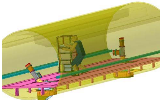
Positionnement 3D des antennes et du récepteur à l'intérieur de l'ATR-42
