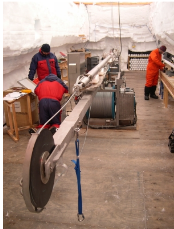
Site de Berkner : la tranchée de forage équipée du carottier en position horizontale
