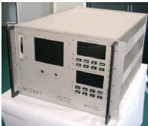
Prototype embarquable de MOZART (dimensions 19" 7U, masse 42 kg)
