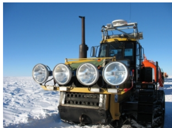
Véhicule du convoi, équipé de phares, de la caméra IR (boîte rectangulaire sur le toit).
