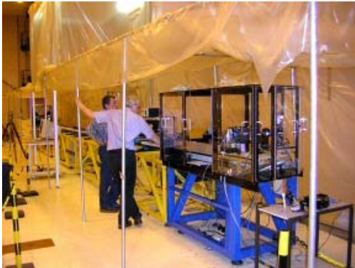
La ligne à retard OHANA (14 m de long) sous surpresseur dans le hall d'intégration
