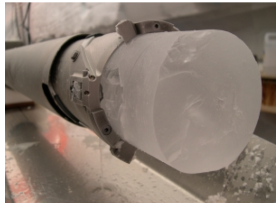
Tête de forage munie de couteaux, et carotte de glace
