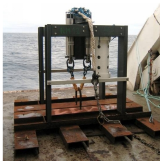
Nouvelle structure de mouillage d'un marégraphe
