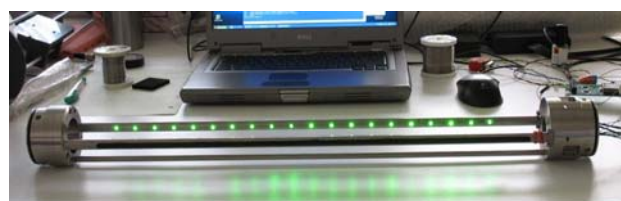
Barrettes optiques à LEDs pour l'éclairage latéral de la colonne d'eau.
