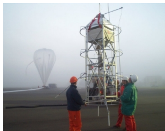
La nacelle SDLA-LAMA est soulevée par le ballon auxiliaire alors que le ballon principal est encore au sol (au fond).
